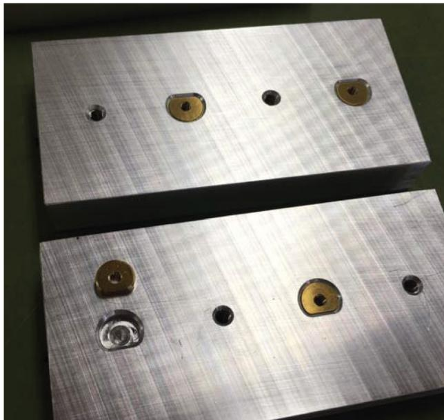
Das Drop-off System erlaubt es dem Kunden die Pass-Position zu halten, aber den Druck unter dem Klischee und dem Alu Block auf- oder abzubauen, ohne dass die Pass-Position verlorengeht.
